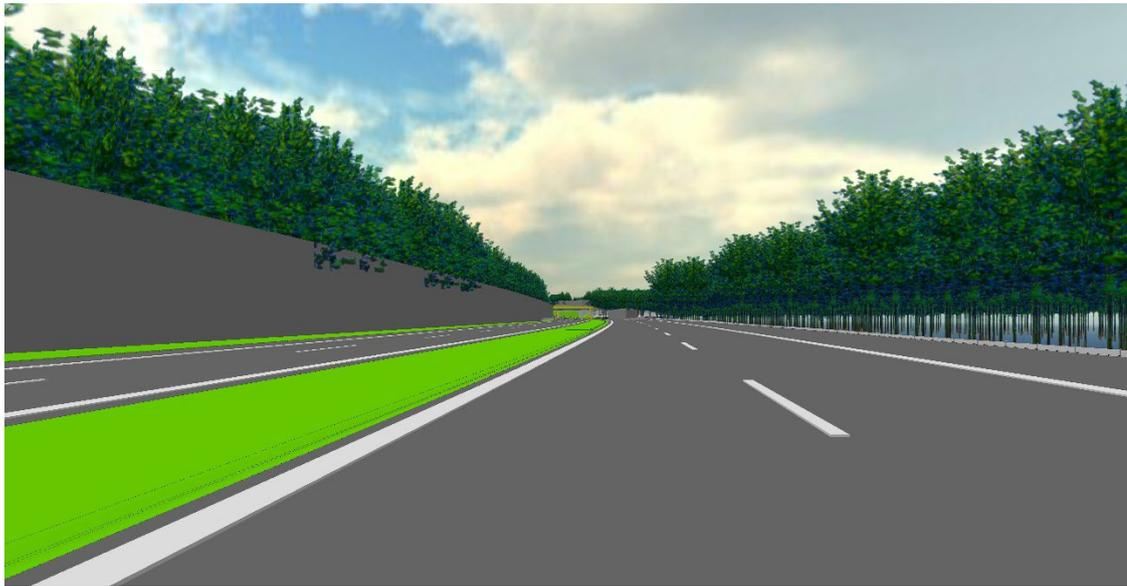
Abbildung 4: Fahrsimulation Richtungsfahrbahn Suhl vor der AS Memmelsdorf mit Übergang  $R = 5.000$  m auf  $R = 3.500$  m
