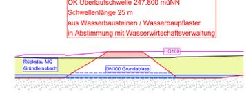
**RQ5: Regelquerschnitt Bypass Dreiecksfläche NO**
