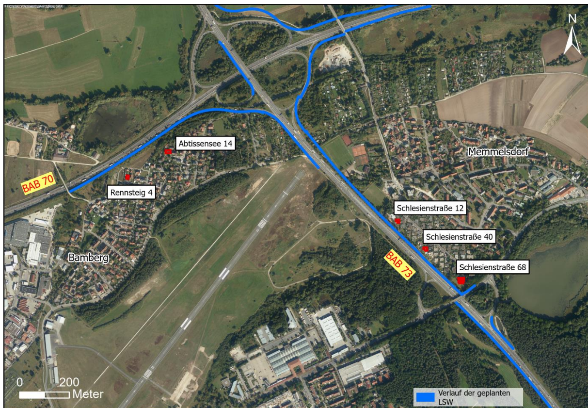
Abbildung 1: Lage der fünf Wohngebäude entlang der BAB 70 und der BAB 73 am Kreuz Bamberg mit dem Verlauf der geplanten LSW (Luftbild: DOP80 ©Bayerische Vermessungsverwaltung 2018).
