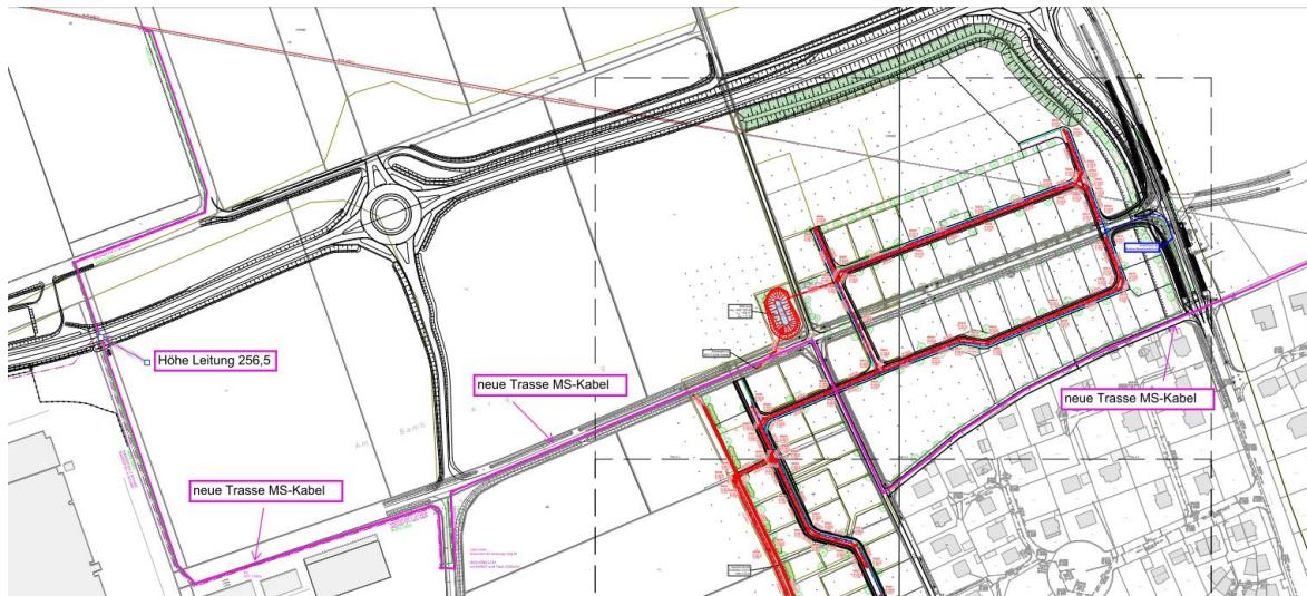
Die Unterquerung der OU Buttenheim erfolgt bei ca. Bau-km 0+551 in einer Tiefenlage von rund 3m unter OK Gelände (256,5)- dabei wird am Schnitt der Entwässerung orientiert.
