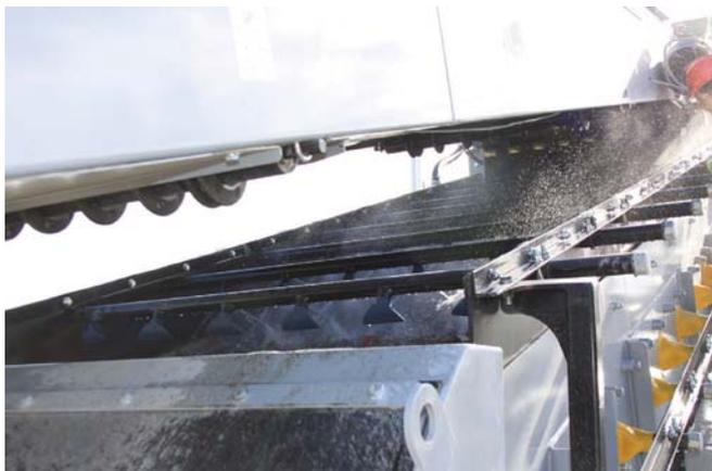
3-Deck-Zuschlagstoffsieb, mit Schüttenwagen für Zugang
