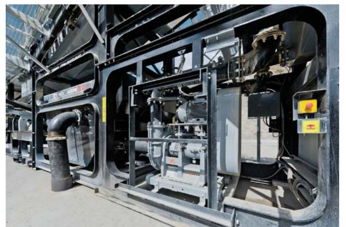
Zentrifugalpumpen, zur Wartung ausziehbar
