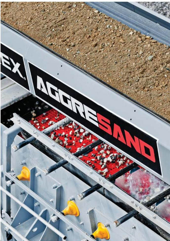
Zuschlagstoffsieb mit separaten Bebrausungsrohren
