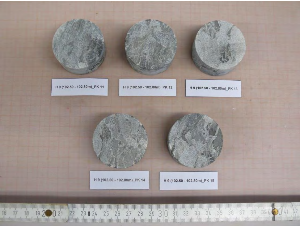
Abbildung 39: H9 (102.550 - 102.80m)_PK 11 bis _PK 15 - VOR Versuch
