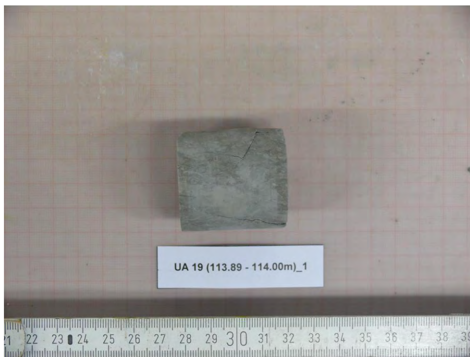
Abbildung 84: UA19 (113.89-114.00m)_1 - NACH Versuch, Bruchbild
