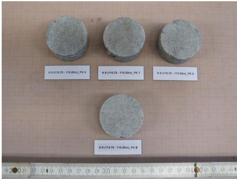
Abbildung 59: H9 (115.70 - 115.80m)_PK 6 bis _PK 9 - VOR Versuch
