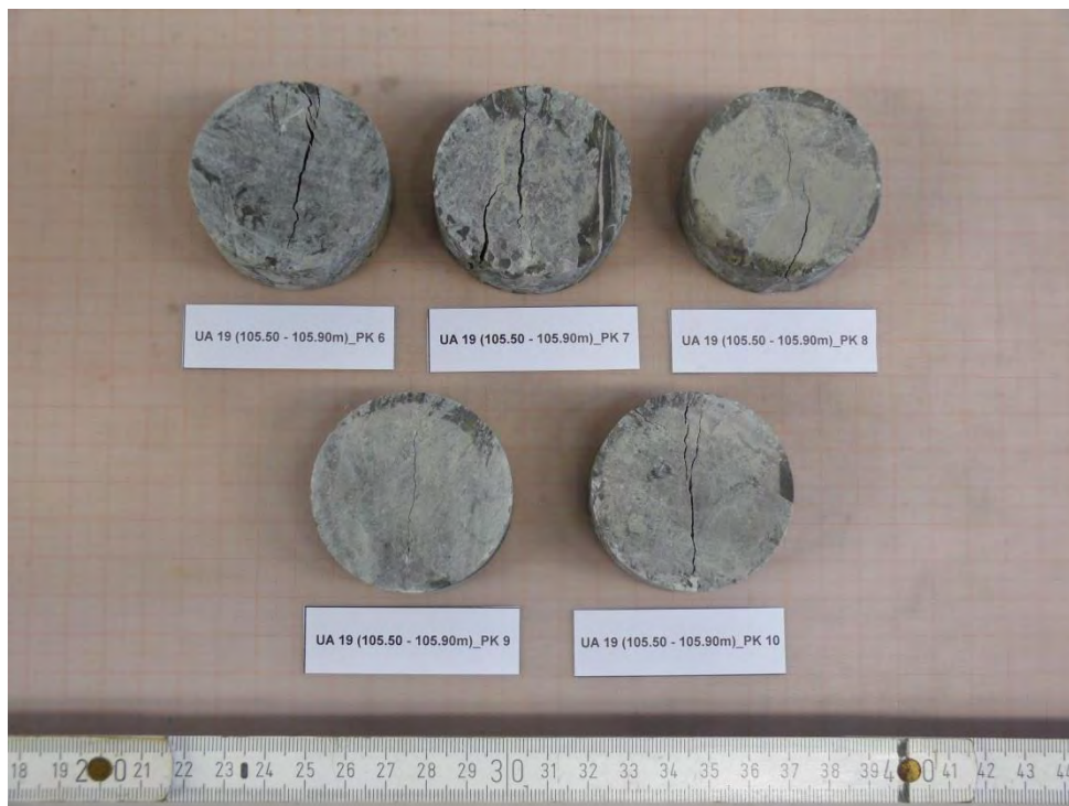
Abbildung 38: UA19 (105.50 - 105.90m)_PK 6 bis _PK 10 - NACH Versuch
