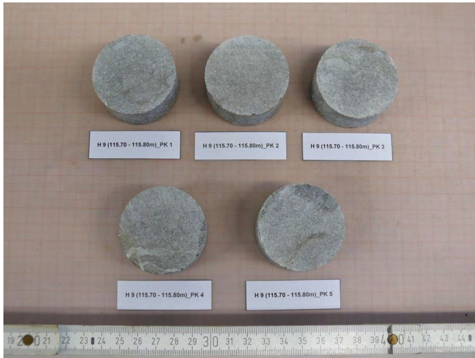
Abbildung 57: H9 (115.70 - 115.80m)_PK 1 bis _PK 5 - VOR Versuch
