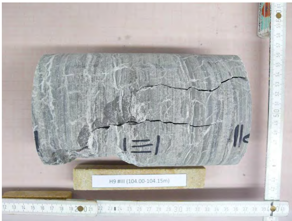
Abbildung 4: H9 #III (104.00-104.15m) - NACH Versuch, Bruchbild
