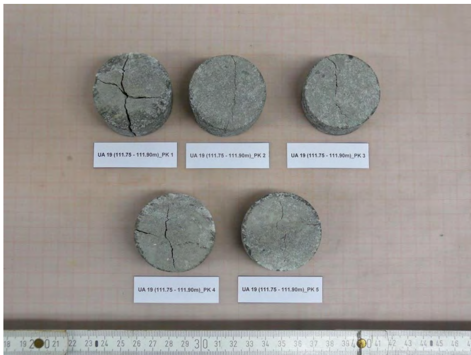
Abbildung 46: UA19 (111.75 - 111.90m)_PK 1 bis _PK 5 - NACH Versuch
