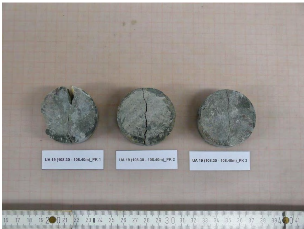
Abbildung 44: UA19 (108.30 - 108.40m)_PK 1 bis _PK 3 - NACH Versuch
