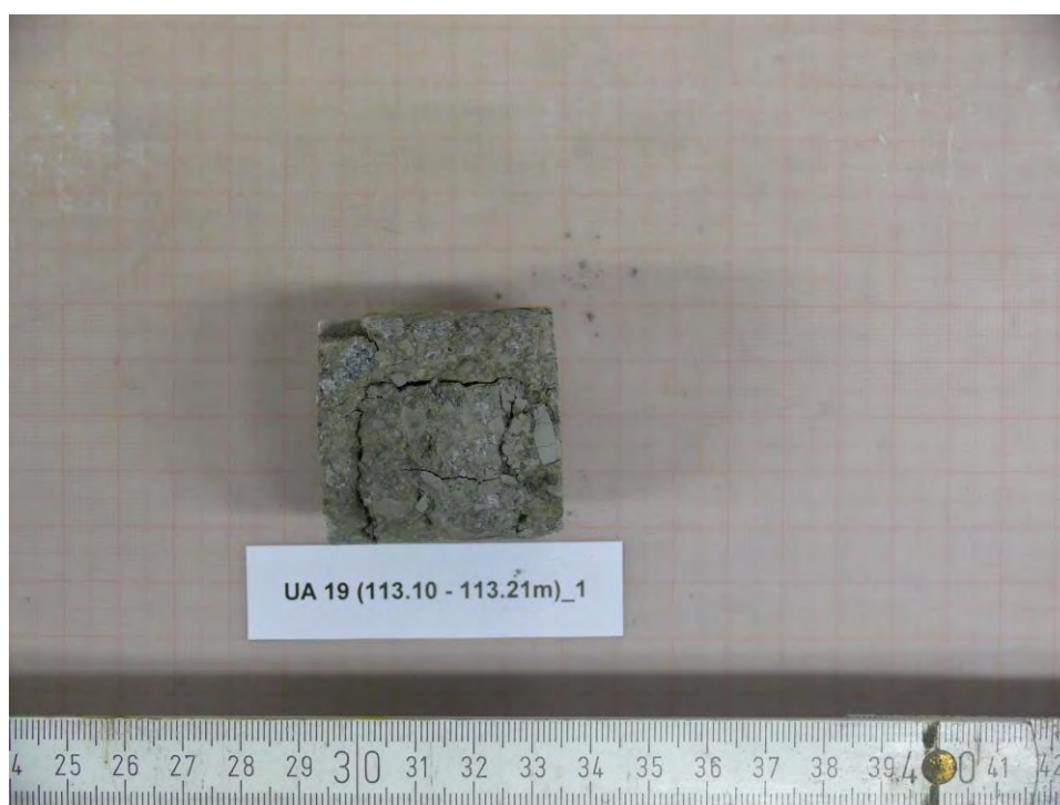
Abbildung 80: UA19 (113.10-113.21m)_1 - NACH Versuch, Bruchbild
