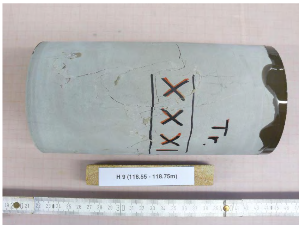
Abbildung 82: H9 (118.55-118.75m) - NACH Versuch, Bruchbild
