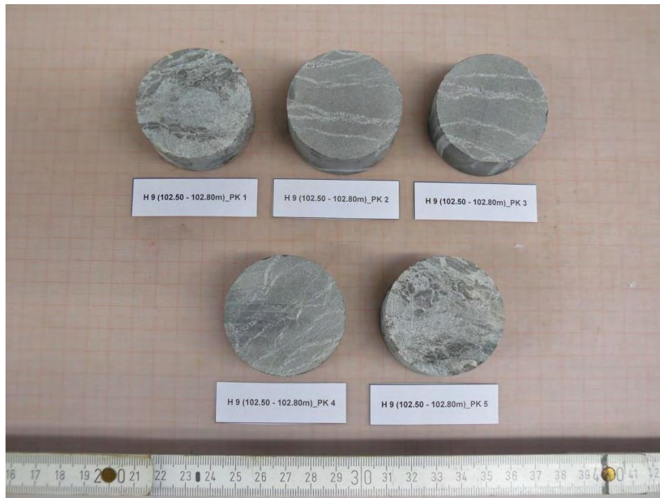
Abbildung 35: H9 (102.50 - 102.80m)_PK 1 bis _PK 5 - VOR Versuch
