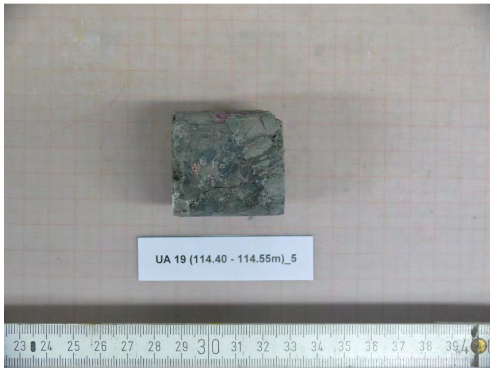
Abbildung 91: UA19 (114.40-114.55m)_5 - NACH Versuch, Bruchbild
