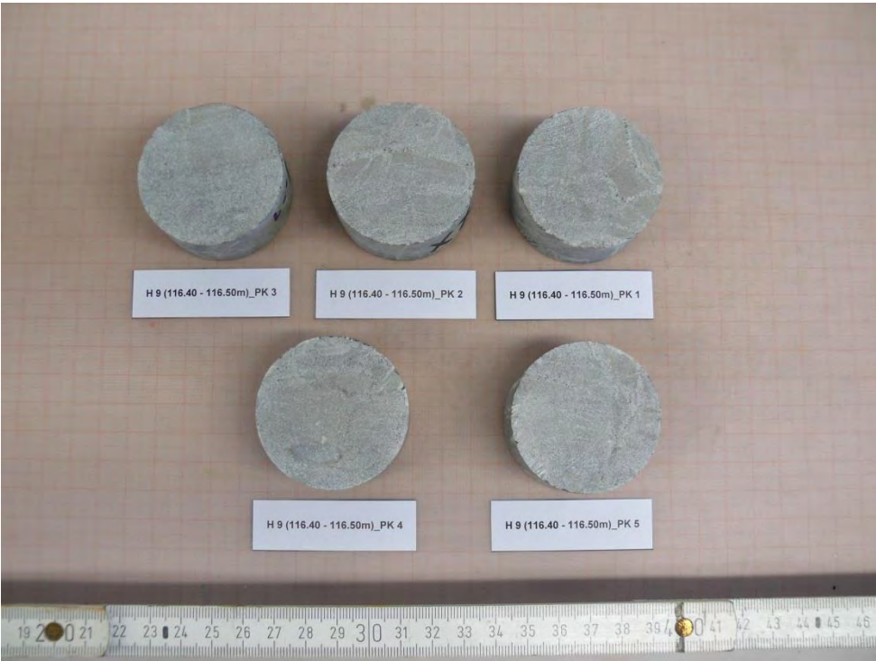
Abbildung 61: H9 (116.40 - 116.50m)_PK 1 bis _PK 5 - VOR Versuch
