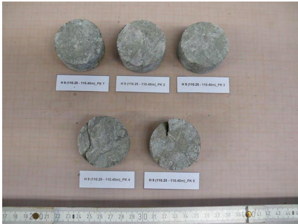
Abbildung 47: H9 (110.25 - 110.40m)_PK 1 bis _PK 5 - VOR Versuch
