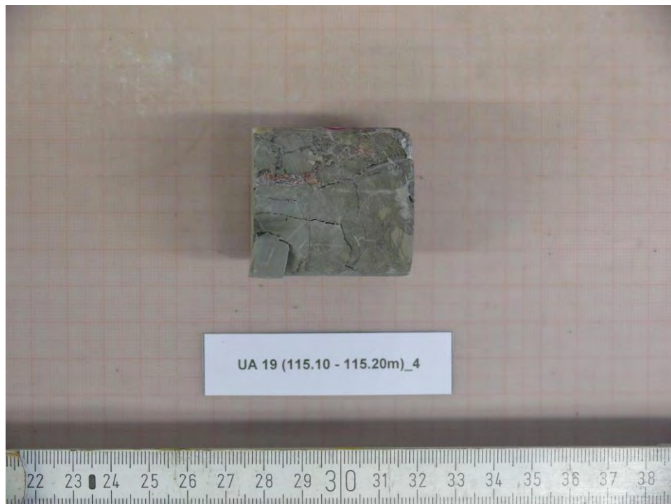
Abbildung 99: UA19 (115.10-115.20m)_4 - NACH Versuch, Bruchbild
