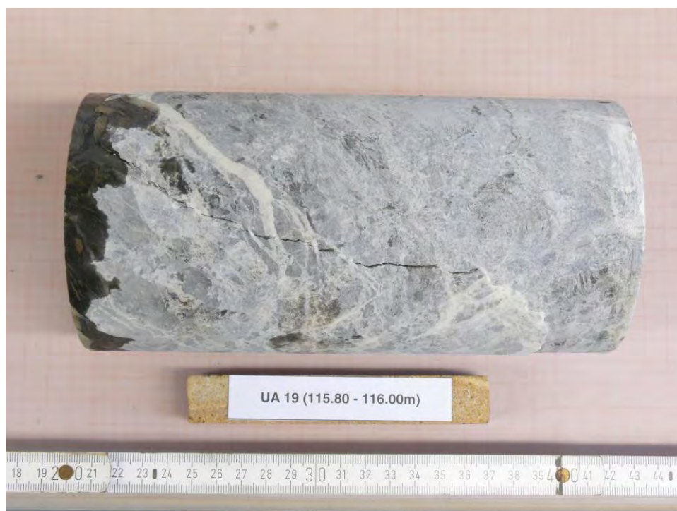
Abbildung 76: UA19 (115.80-116.00m) - NACH Versuch, Bruchbild
