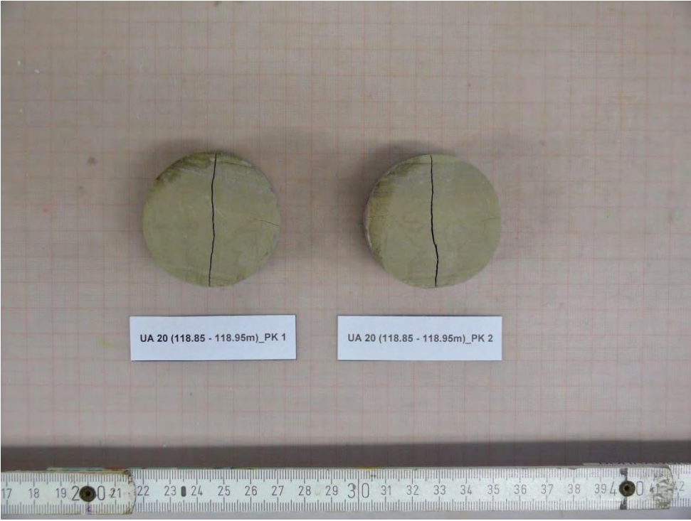
Abbildung 46: UA20 (118.85 - 118.95m)_PK 1 bis _PK 2 - NACH Versuch
