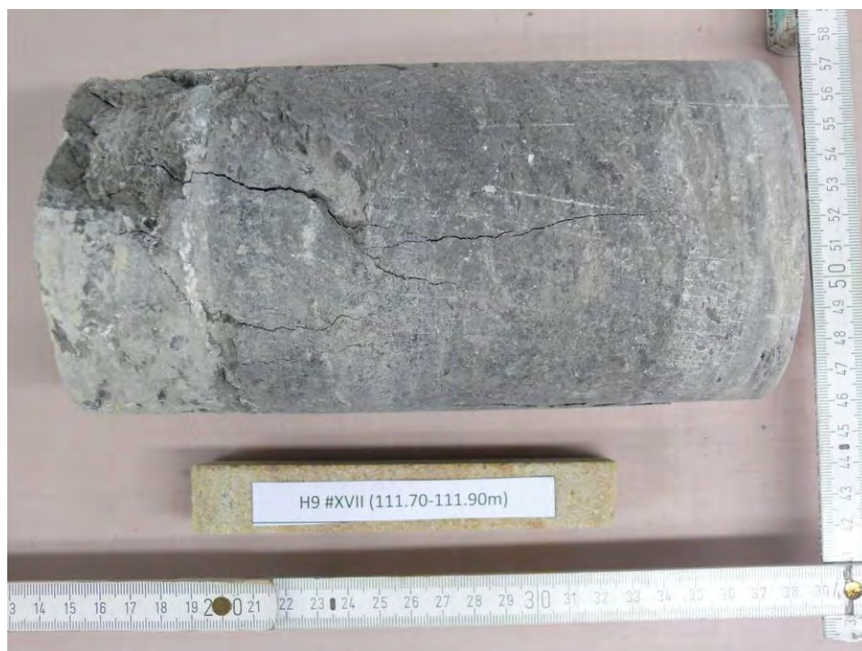
Abbildung 20: H9 #XVII (111.70-111.90m) - NACH Versuch, Bruchbild
