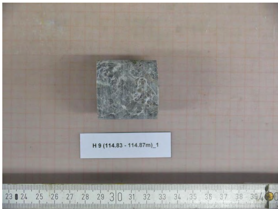
Abbildung 88: H9 (114.83-114.87m)_1 - NACH Versuch, Bruchbild
