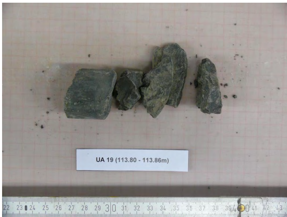
Abbildung 82: UA19 (113.34-113.43m) – Herstellung Prüfkörper nicht möglich
