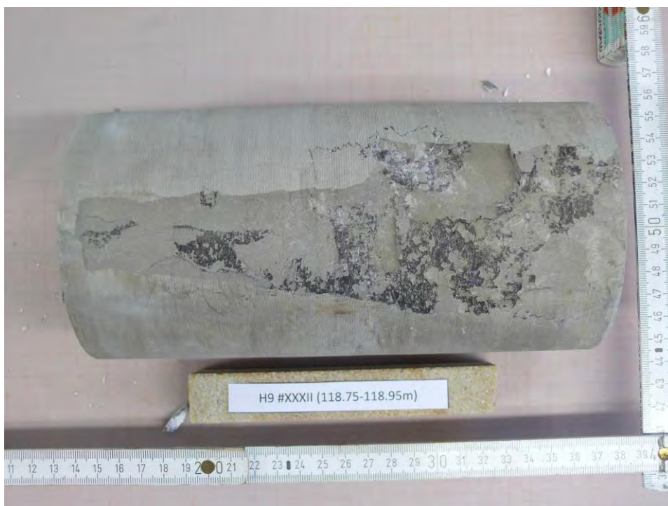
Abbildung 34: H9 #XXXII (118.75-118.95m) - NACH Versuch, Bruchbild
