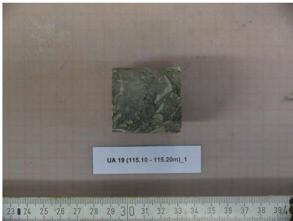
Abbildung 96: UA19 (115.10-115.20m)_1 - NACH Versuch, Bruchbild
