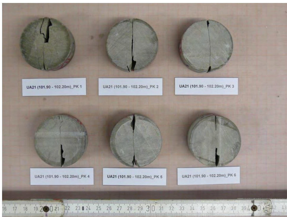
Abbildung 42: UA21 (101.90 - 101.20m)_PK 1 bis _PK 6 - NACH Versuch
