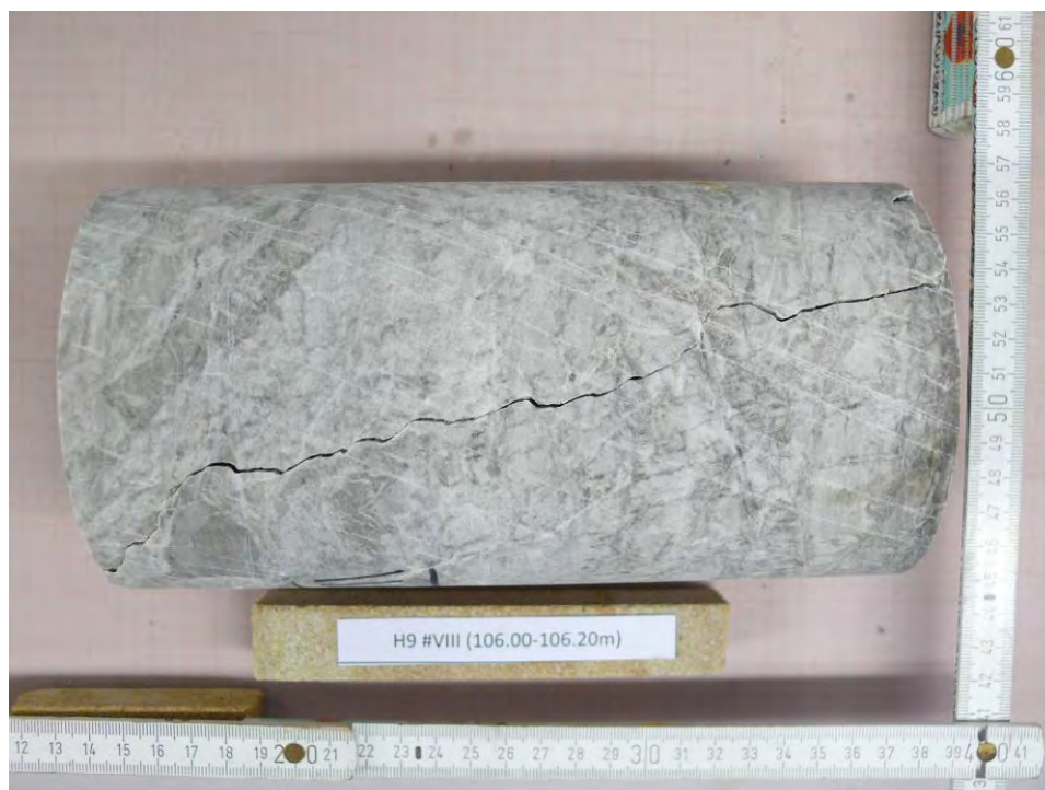
Abbildung 8: H9 #VIII (106.00-106.20m) - NACH Versuch, Bruchbild
