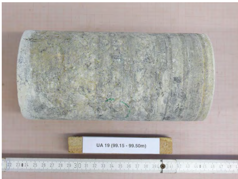
Abbildung 68: UA19 (99.15-99.50m) - NACH Versuch, Bruchbild
