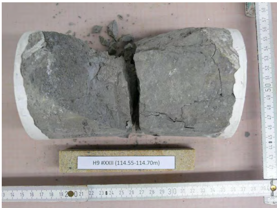
Abbildung 26: H9 #XXII (114.55-114.70m) - NACH Versuch, Bruchbild
