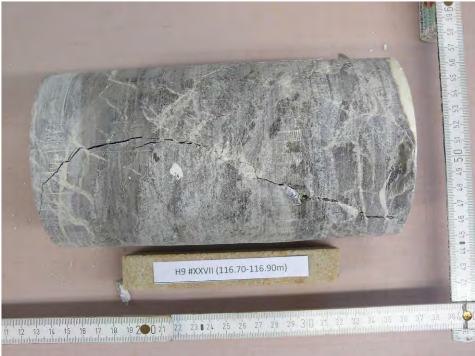
Abbildung 30: H9 #XXVII (116.70-116.90m) - NACH Versuch, Bruchbild
