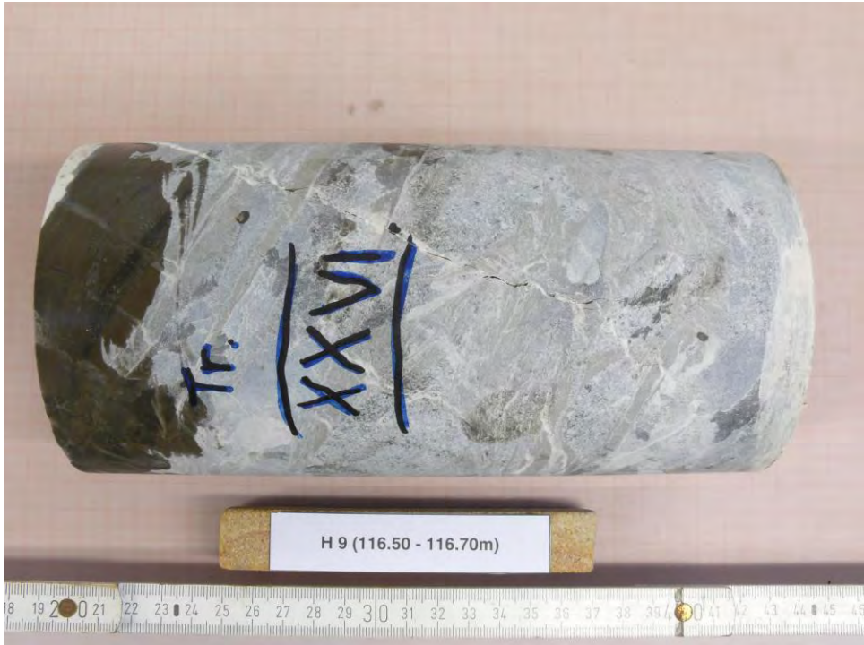
Abbildung 80: H9 (116.50-116.70m) - NACH Versuch, Bruchbild
