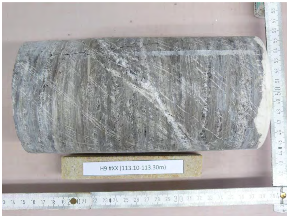
Abbildung 24: H9 #XX (113.10-113.30m) - NACH Versuch, Bruchbild
