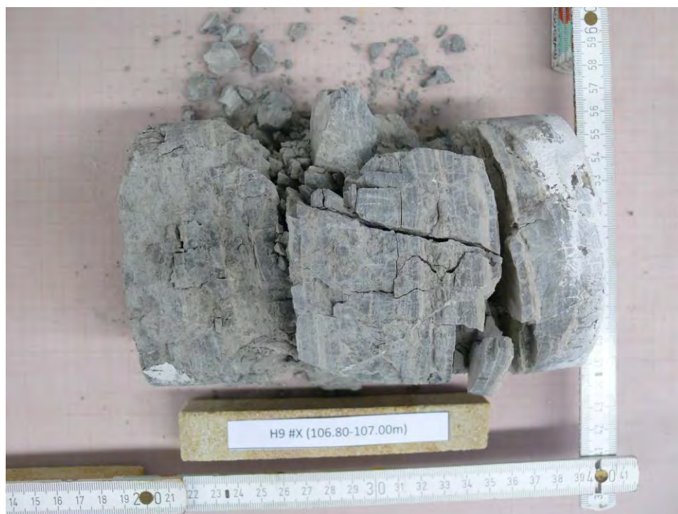
Abbildung 10: H9 #X (106.80-107.00m) - NACH Versuch, Bruchbild
