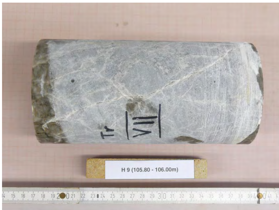
Abbildung 74: H9 (105.80-106.00m) - NACH Versuch, Bruchbild
