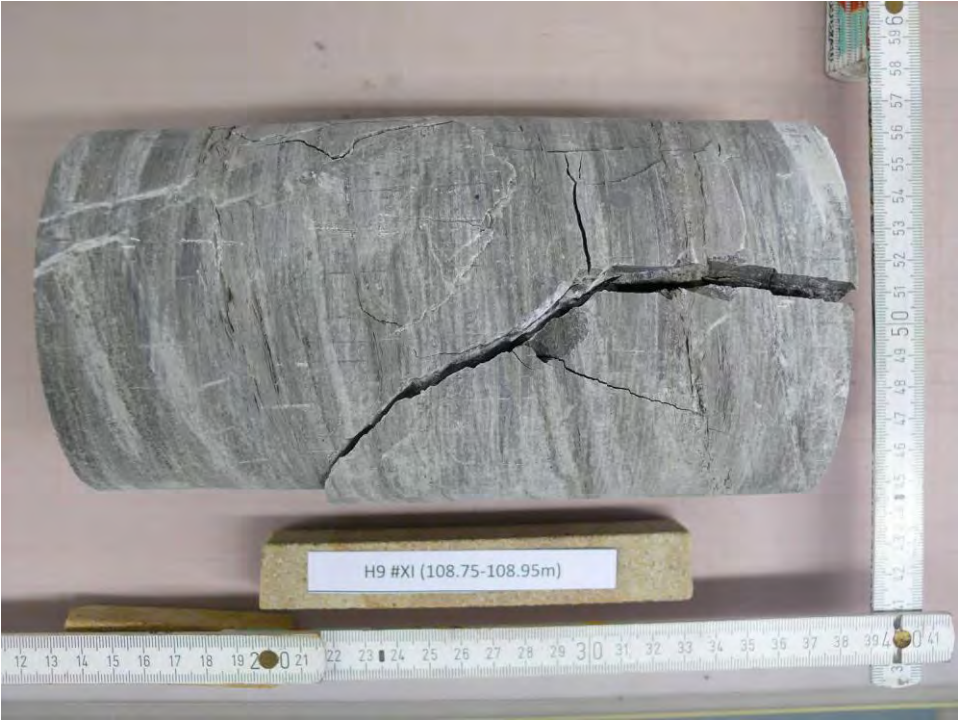
Abbildung 12: H9 #XI (108.75-108.95m) - NACH Versuch, Bruchbild
