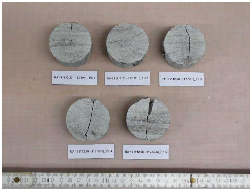
Abbildung 48: UA19 (112.20 - 112.50m)_PK 1 bis _PK 5 - NACH Versuch
