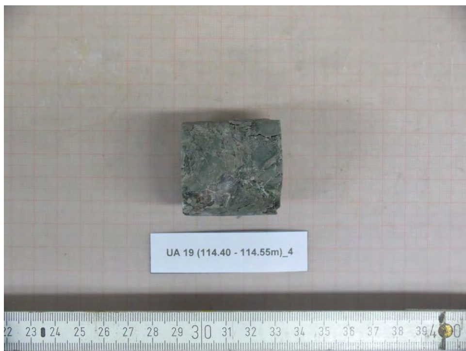
Abbildung 90: UA19 (114.40-114.55m)_4 - NACH Versuch, Bruchbild
