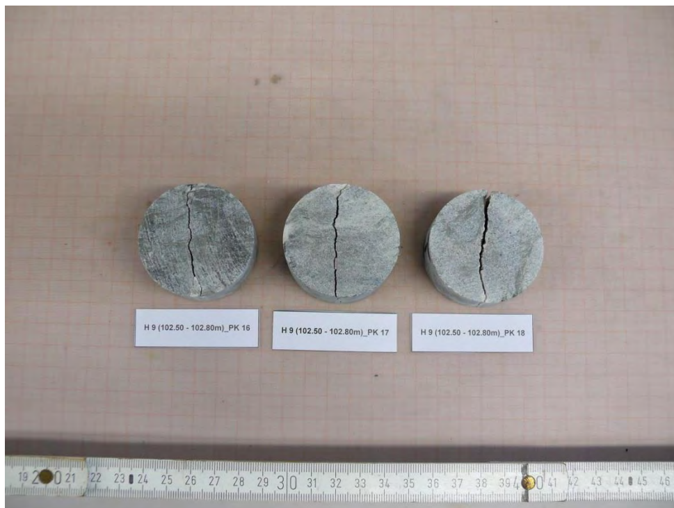
Abbildung 42: H9 (102.50 - 102.80m)_PK 16 bis _PK 18 - NACH Versuch
