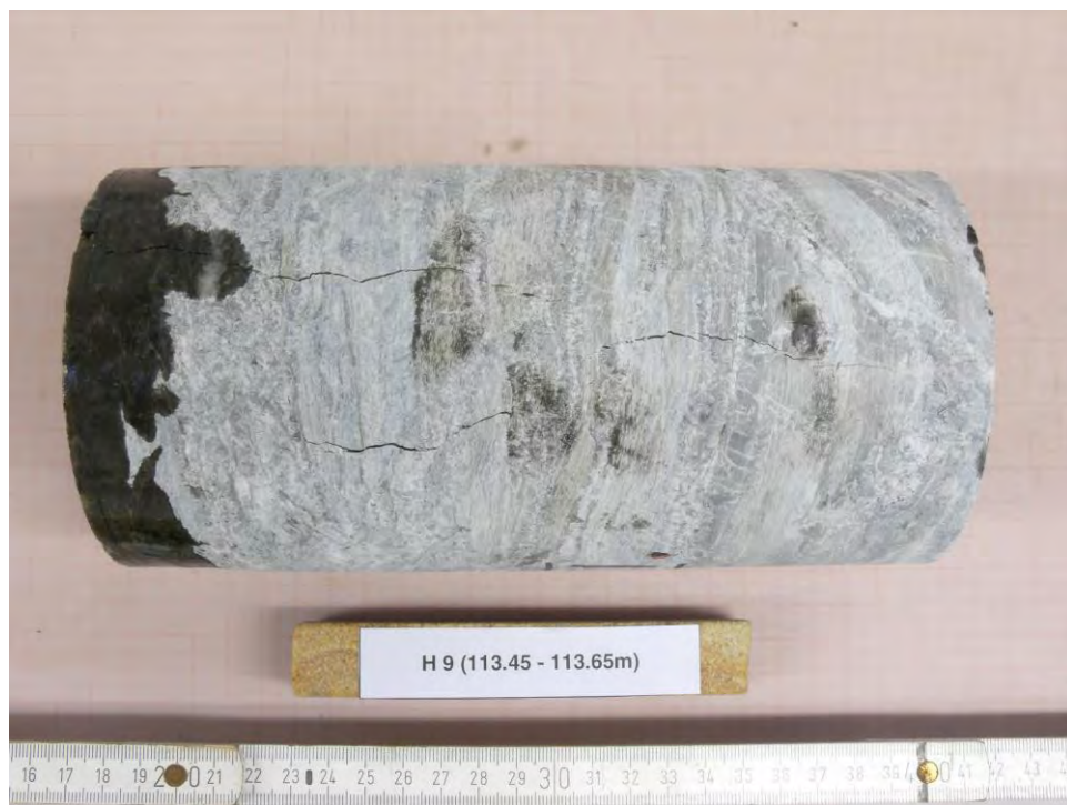
Abbildung 78: H9 (113.45-113.65m) - NACH Versuch, Bruchbild
