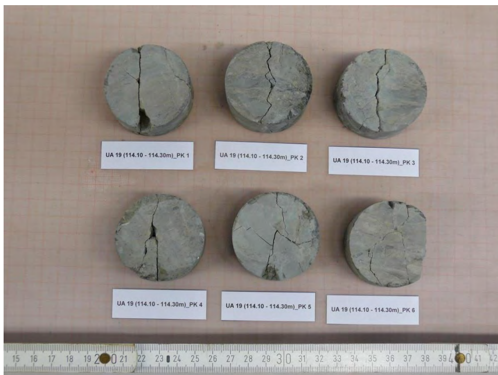
Abbildung 56: UA19 (114.10 - 114.30m)_PK 1 bis _PK 6 - NACH Versuch
