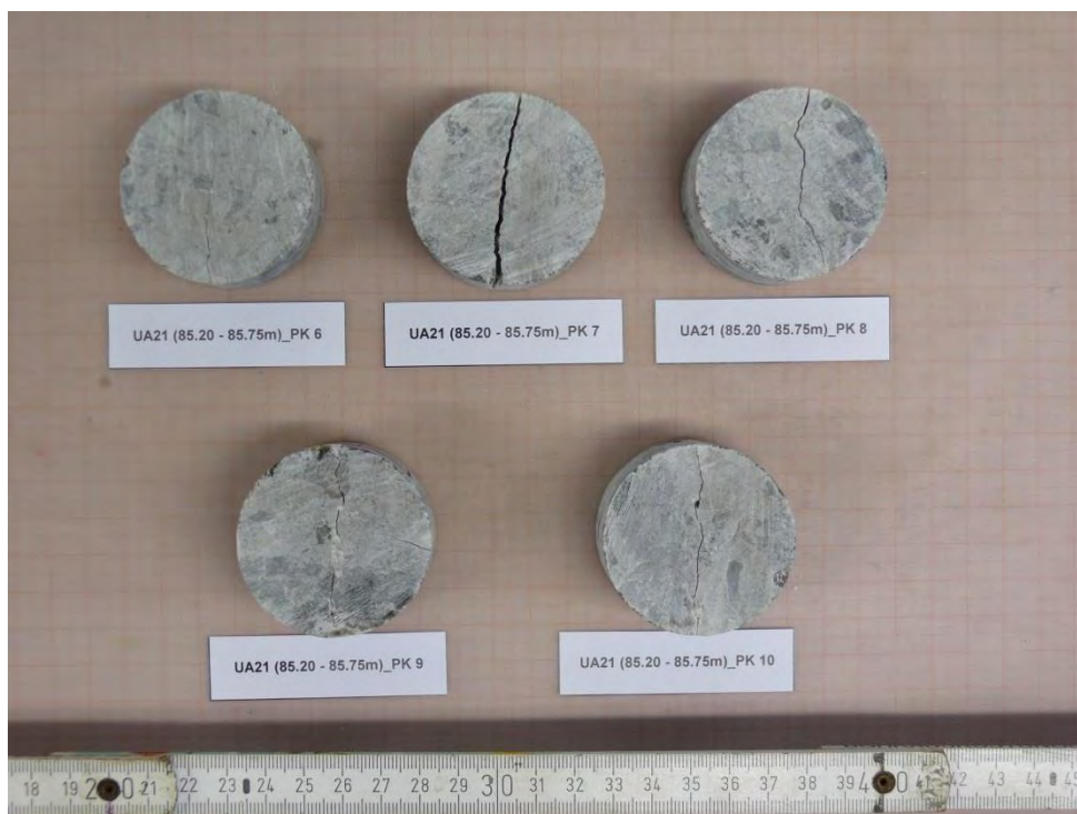
Abbildung 32: UA21 (85.20 - 85.75m)_PK 6 bis _PK 10 - NACH Versuch
