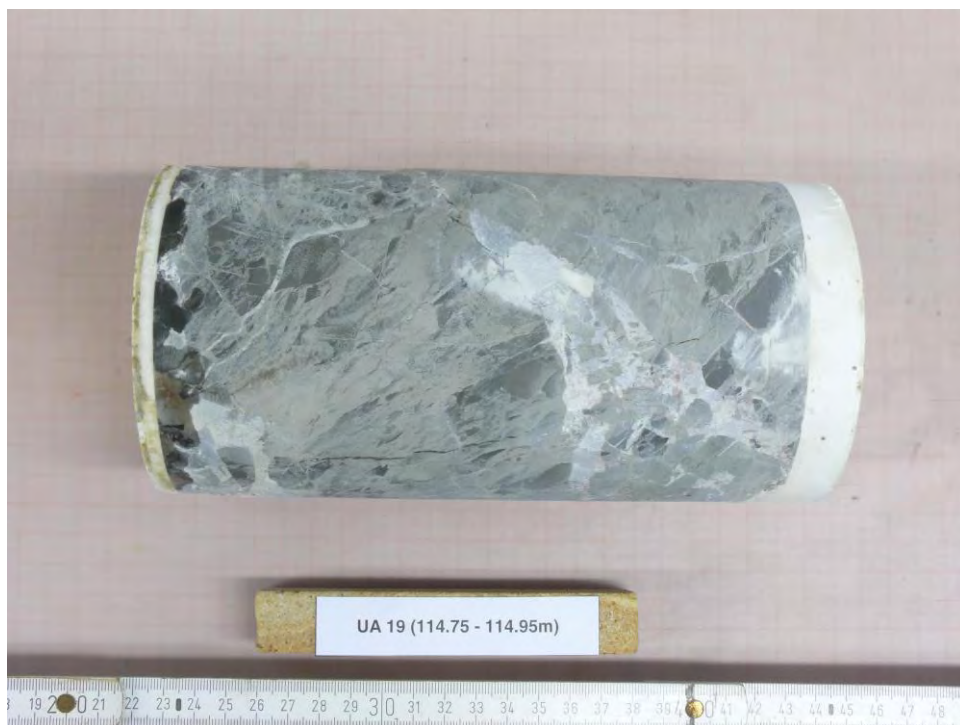
Abbildung 74: UA19 (114.75-114.95m) - NACH Versuch, Bruchbild
