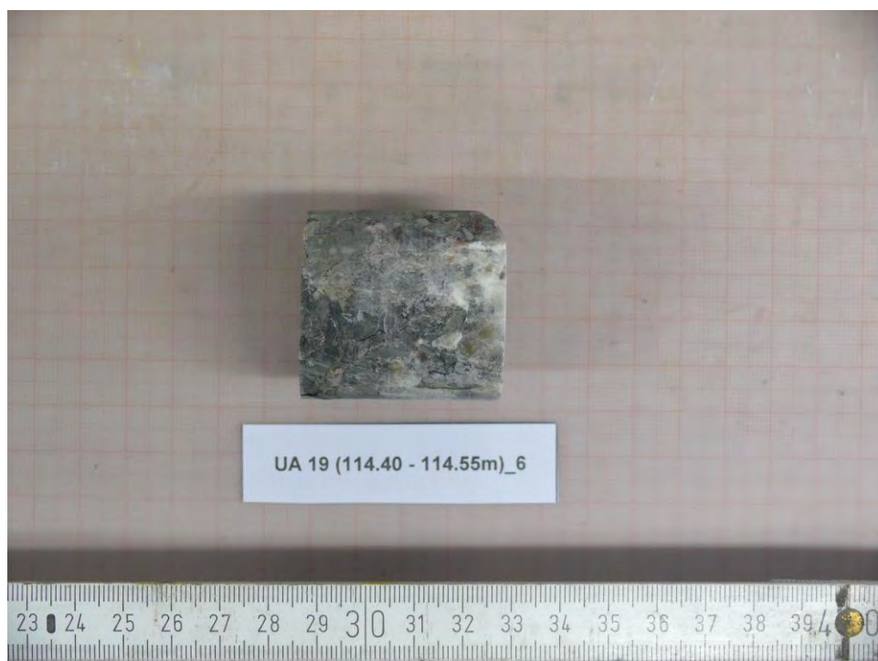
Abbildung 92: UA19 (114.40-114.55m)_6 - NACH Versuch, Bruchbild
