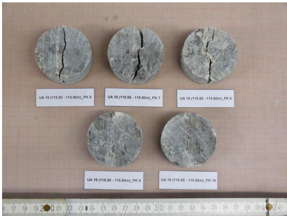
Abbildung 62: UA19 (115.50 - 115.80m)_PK 6 bis _PK 10 - NACH Versuch
