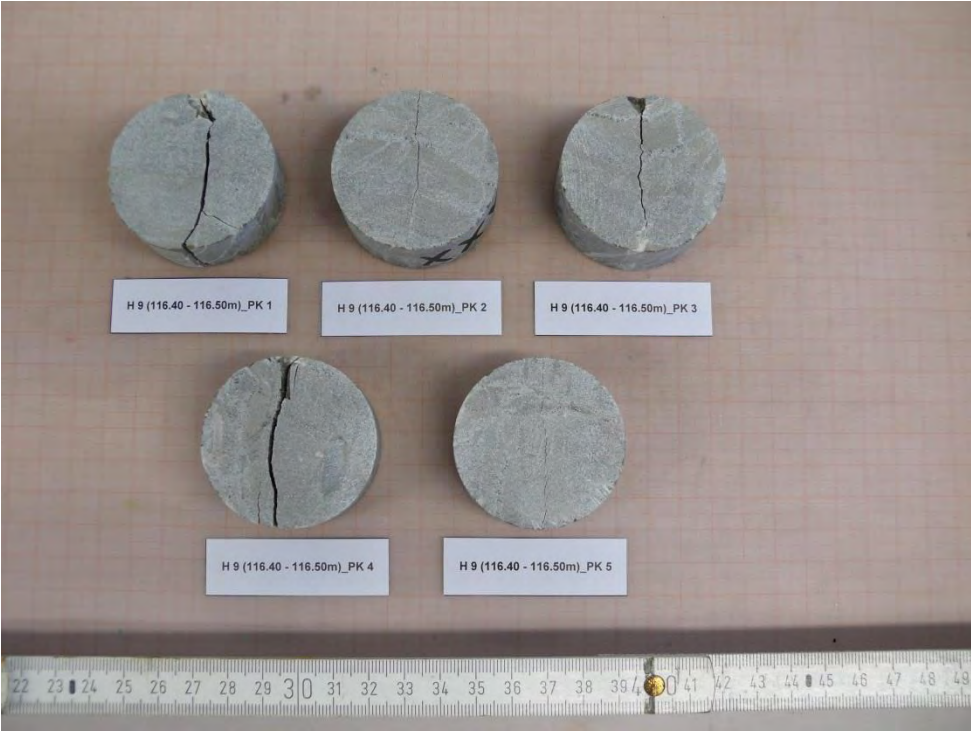
Abbildung 62: H9 (116.40 - 116.50m)_PK 1 bis _PK 5 - NACH Versuch
