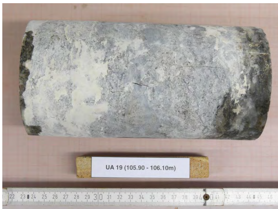
Abbildung 70: UA19 (105.90-106.10m) - NACH Versuch, Bruchbild
