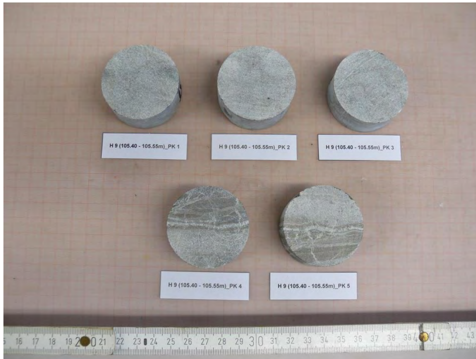
Abbildung 43: H9 (105.40 - 105.55m)_PK 1 bis _PK 5 - VOR Versuch
