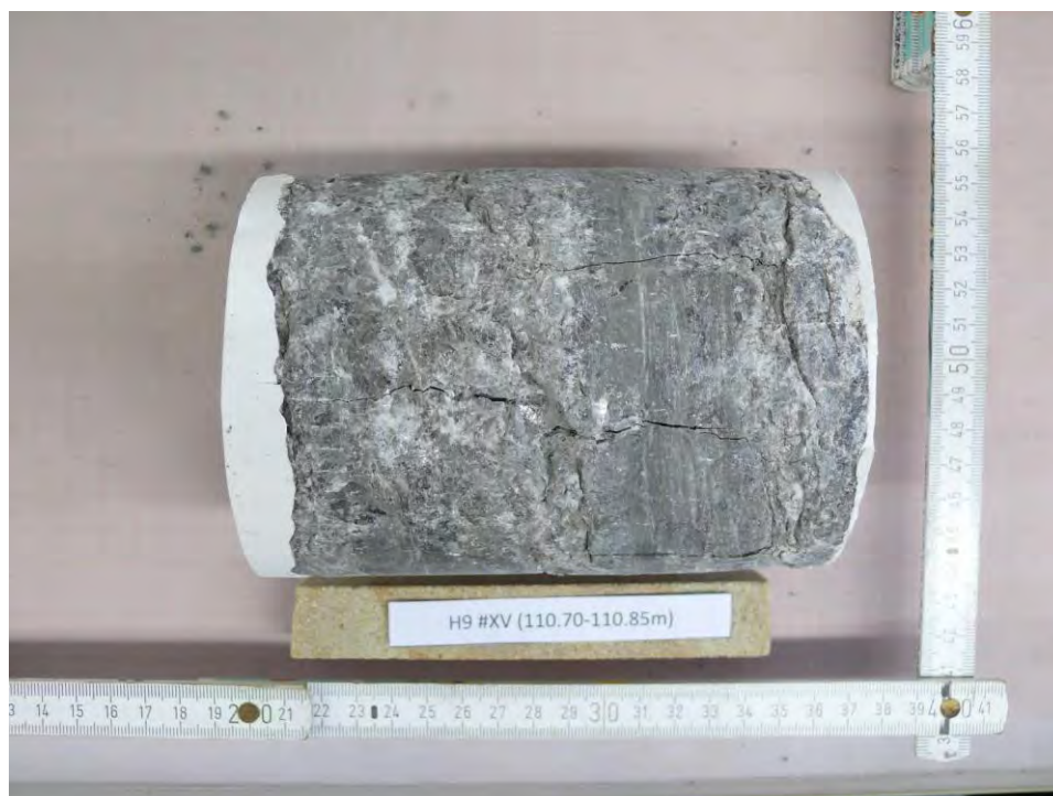
Abbildung 18: H9 #XV (110.70-110.85m) - NACH Versuch, Bruchbild
