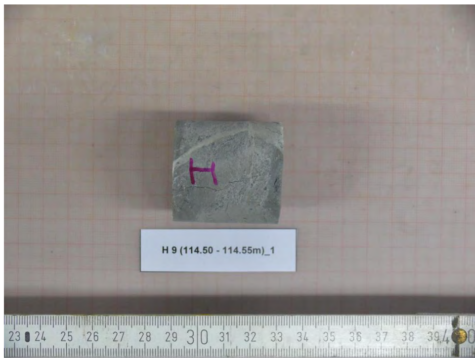
Abbildung 84: H9 (114.50-114.55m)_1 - NACH Versuch, Bruchbild
