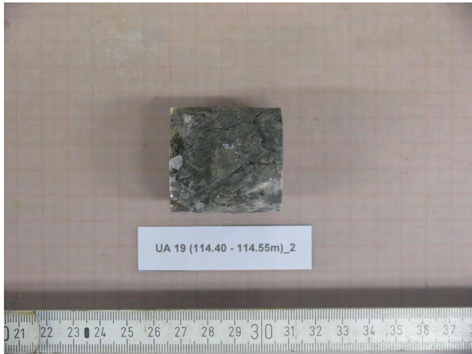
Abbildung 87: UA19 (114.40-114.55m)_2 - NACH Versuch, Bruchbild
