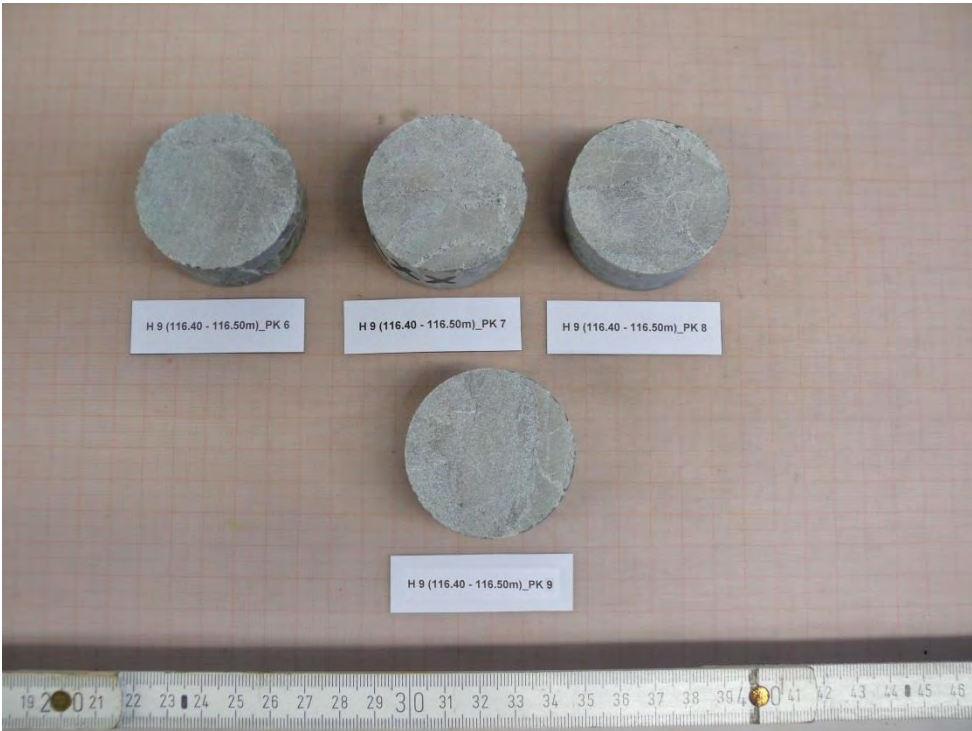
Abbildung 63: H9 (116.40 - 116.50m)_PK 6 bis _PK 9 - VOR Versuch
