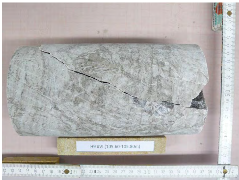
Abbildung 6: H9 #VI (105.60-105.80m) - NACH Versuch, Bruchbild
