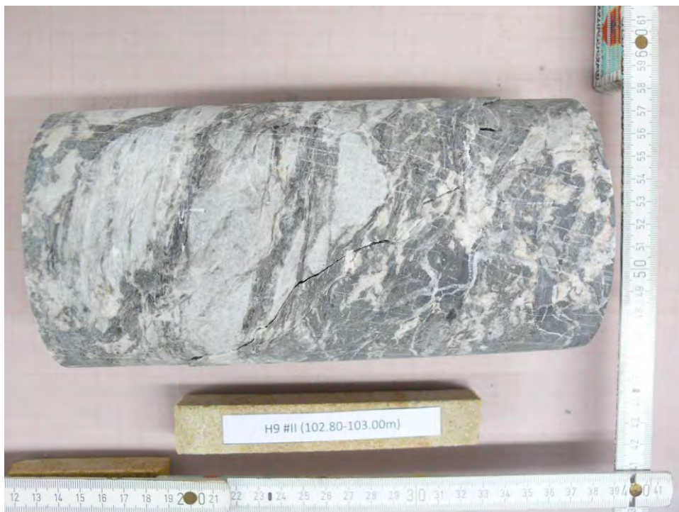
Abbildung 2: H9 #II (102.80-103.00m) - NACH Versuch, Bruchbild
