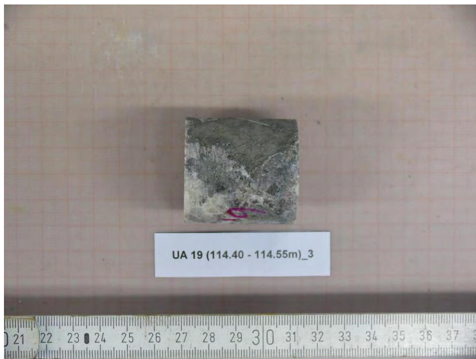
Abbildung 88: UA19 (114.40-114.55m)_3 - NACH Versuch, Bruchbild
