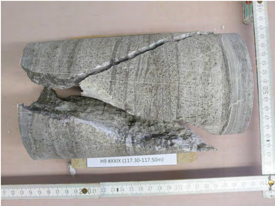
Abbildung 32: H9 #XXIX (117.30-117.50m) - NACH Versuch, Bruchbild
