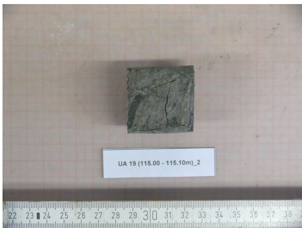
Abbildung 94: UA19 (115.00-115.10m)_1 - NACH Versuch, Bruchbild
