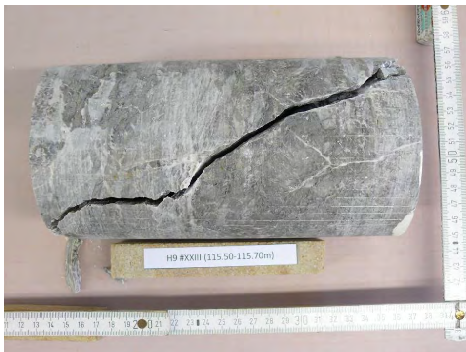
Abbildung 28: H9 #XXIII (115.50-115.70m) - NACH Versuch, Bruchbild
