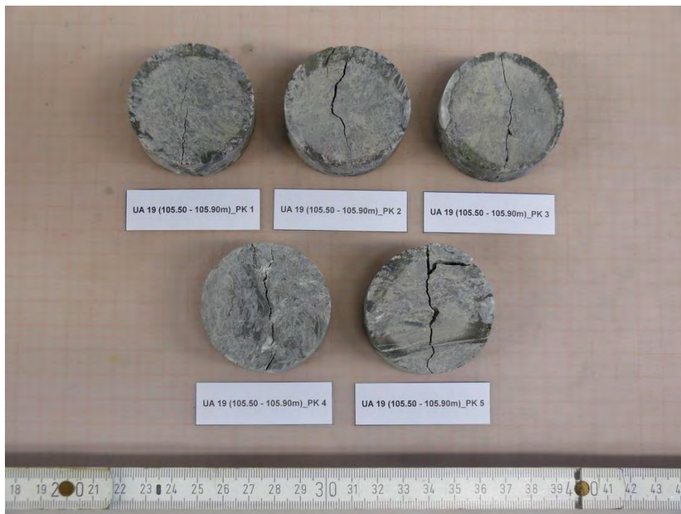
Abbildung 36: UA19 (105.50 - 105.90m)_PK 1 bis _PK 5 - NACH Versuch
