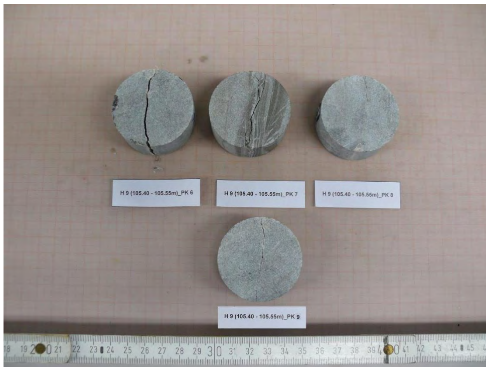
Abbildung 46: H9 (105.40 - 105.55m)_PK 6 bis _PK 9 - NACH Versuch
