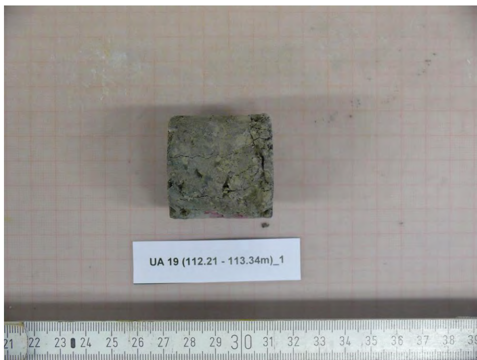
Abbildung 78: UA19 (112.21-113.34m)_1 - NACH Versuch, Bruchbild
