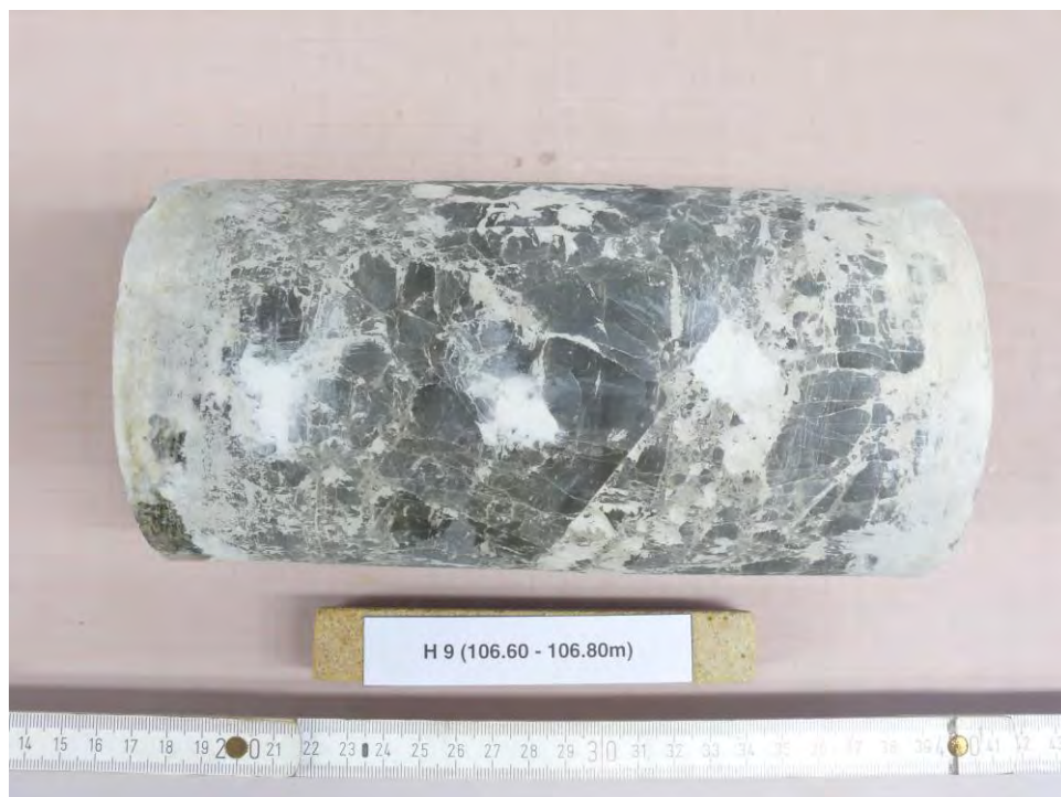
Abbildung 76: H9 (106.60-106.80m) - NACH Versuch, Bruchbild
