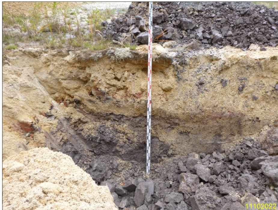
Bild 3: Aufschluss 3 (A3), Probenentnahme aus Gümbelschem Sandstein und Rhätton, entnommene Proben: A3SP1 (G. Sandstein) und A3TP1 (Rhätton)
