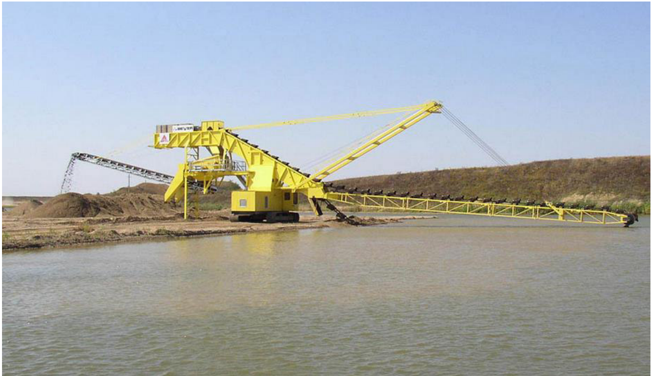
Abbildung 4-1: Beispielhafte Darstellung eines landgestützten Eimerkettenbaggers zur Kiesgewinnung (anderer Hersteller - Abb. beyer-suedost.de)
