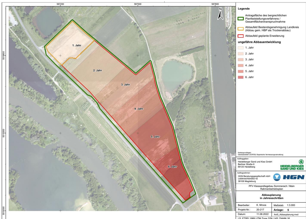
Abbildung 2: Abbauentwicklung in den Abbaufeldern der genehmigten sowie der geplanten Erweiterung (Stand 11.08.2022).
