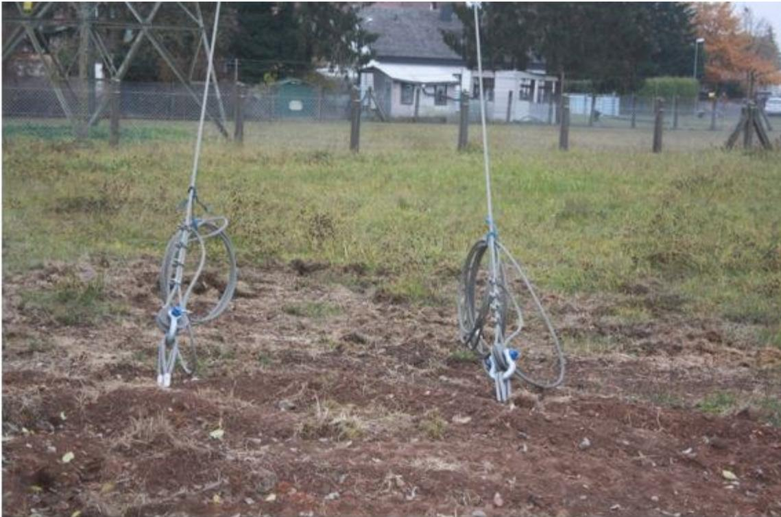
Abbildung 17: ins Erdreich eingebrachte Anker
