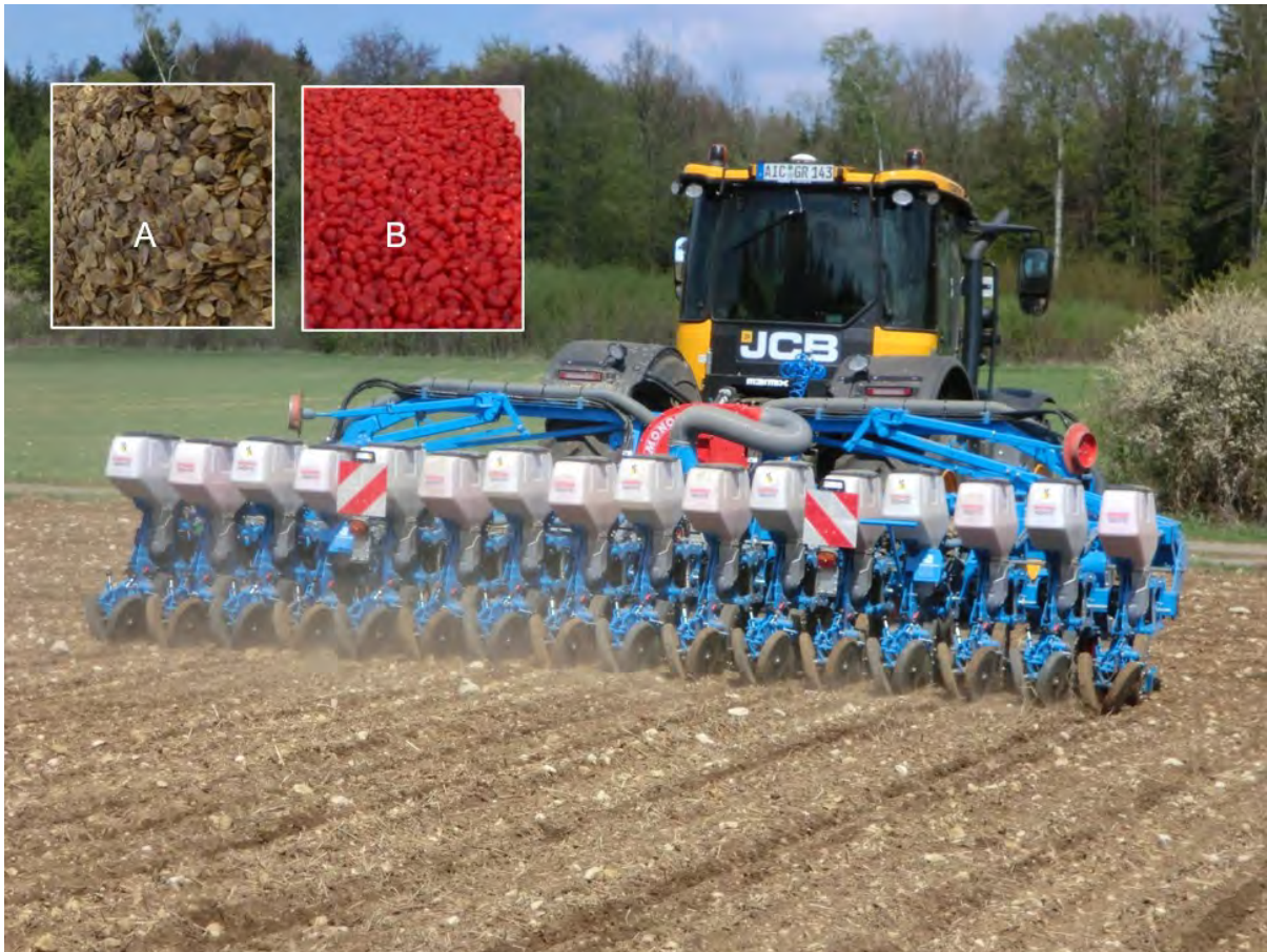
Abbildung 5: Sämaschine des Dienstleisters Donau Silphie - Aussaat von Silphie (A) und Mais (B) in unterschiedlichen Sätiefen
