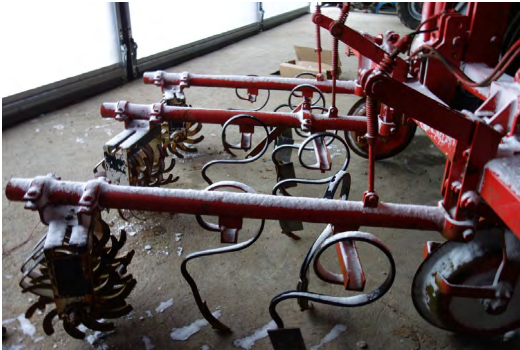
Abbildung 40: Federzinkenhacke mit Rollhacke
